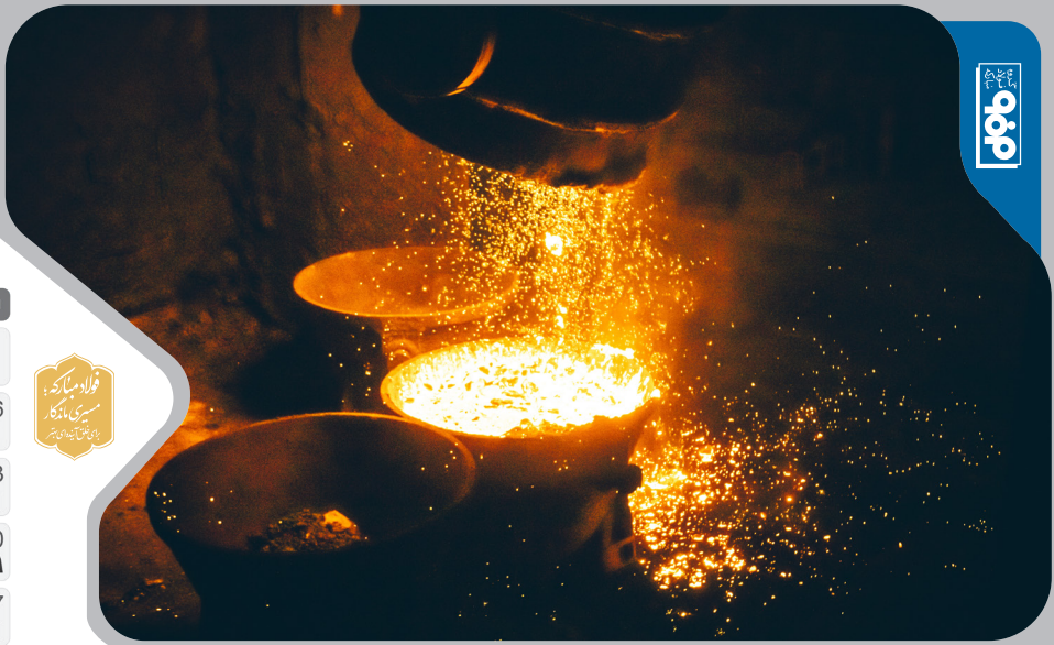
ناحیه فولادسازی و ریخته‌گری مداوم _ تخلیه ضایعات غیرفلزی ته پاتیل مذاب در پاتیل سربراه واحد LTS
